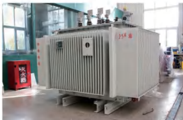
整流变压器 Rectifier transformer
