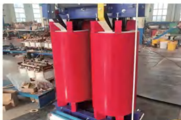
试验变压器 Test transformer
